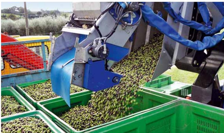
Scarico dal serbatoio della macchina alle casse per il trasporto delle olive al frantoio. L'operazione è veloce, i frutti, preservati da ogni contatto con reti e terra, non subiscono altra manipolazione prima della frangitura
